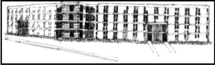
**Figura 1.** Edificios para becarios, construidos entre 1962 y 1971. Primeras obras universitarias que utilizan prefabricado como solución tecnológica en entresijos y cubiertas.
